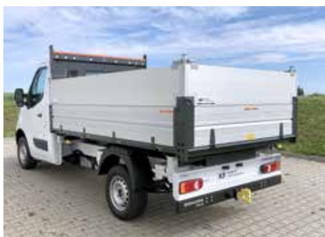
Umbausatz zum Hinterkipper mit seitlicher Bordwanderhöhung
