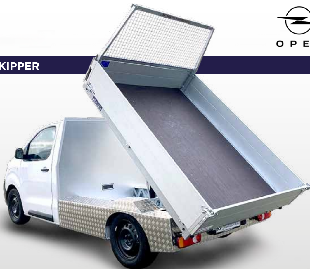
Opel Vivaro mit Hinterkipperaufbau und Leiterträger
