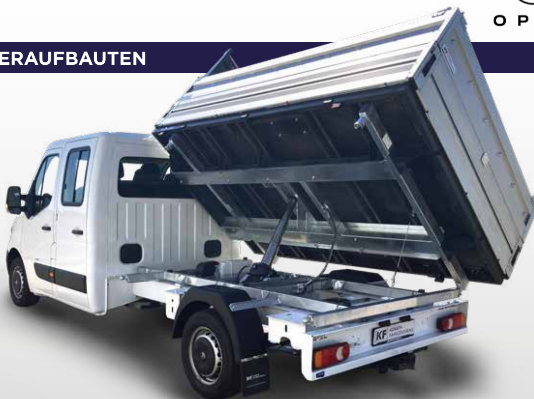
Opel Movano mit Werkspritsche und Umbausatz zum Dreiseitenkipper
