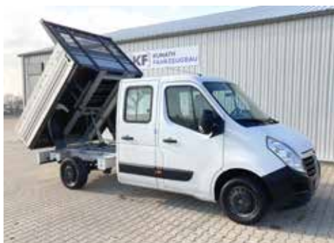
Umbausatz zum Hinterkipper mit seitlicher Bordwanderhöhung
