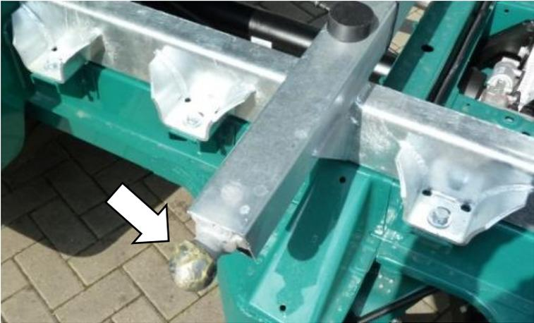
Die vier Kugelaufnahmen der Kiplager sind mit Fett versehen. Bei verunreinigtem Fett ist dieses zu entfernen und neuen aufzutragen. Dabei ist zu beachten, dass die Kugelpfannen (Gegenstück) ebenfalls zu reinigen sind.
