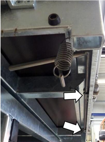
Die beweglichen Teile der hinten zentralen Bordwandverriegelung mit ausreichend Fett versorgen.
