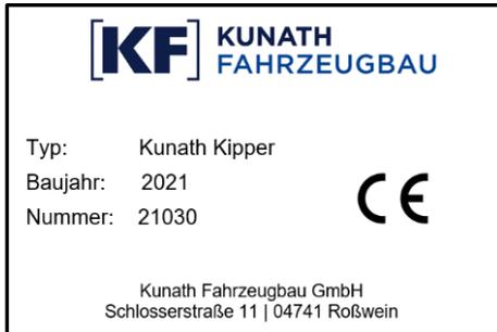
Das Typenschild befindet sich auf der linken Seite der vorderen Bordwand. Für Anfragen oder Ersatzteilbestellungen immer Typ, Aufbau-nummer, Baujahr und die Fahrzeug-Identifizierungsnummer angeben.
