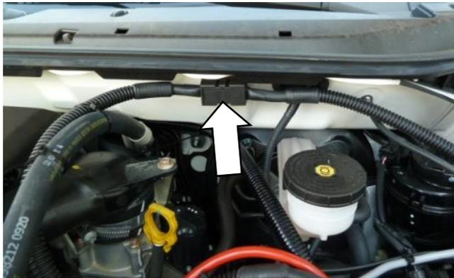
Hauptsicherung 200 A (Variante mit Verschluss)
