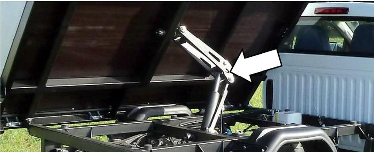
Hydraulikzylinder mit Scherenmechanik
